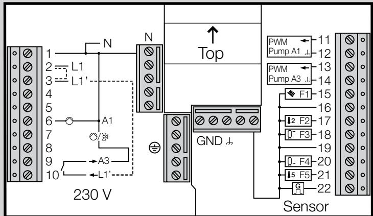
~230 В, коммутационная нагрузка реле 2(2) А, ~250 В
